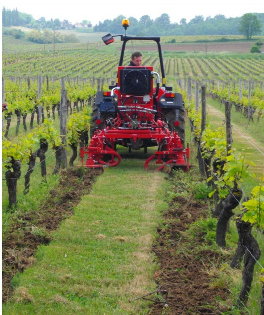
utilisée pour le déchaussage en sortie d'hiver mais également tout au long de la saison pour retourner un enherbement bien implanté (en retournant la terre les herbes sont enfouies). Elle ameublit le sol et prépare les binages interceps ultérieurs, notamment ceux réalisés à l'aide de lame. La décavaillonneuse est efficace lors de présence d'herbes très développées. En raison des risques d'arrachages élevés, la vitesse d'avancement doit être relativement réduite (entre 1,5 et 2,5 km/h).
