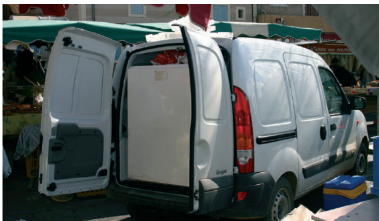
Photo 25 : Véhicule équipé d'un caisson frigorifique.
