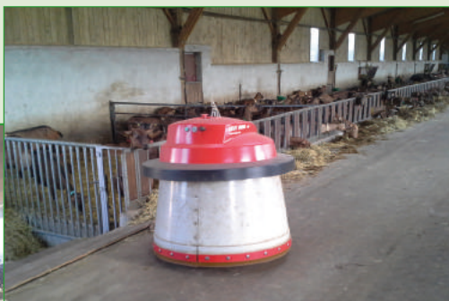
Les repousses sont réalisées avec un robot
